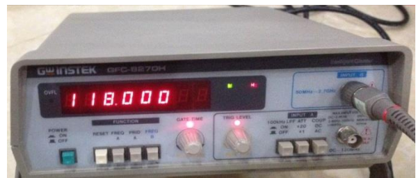
Gambar 4.15 Hasil Pengukuran 118.000 MHz dengan Frequency Counter
