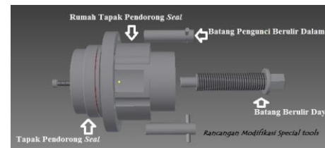
Gambar 3 Disassembly modifikasi special tools pasang seal (Sumber: Pribadi)
